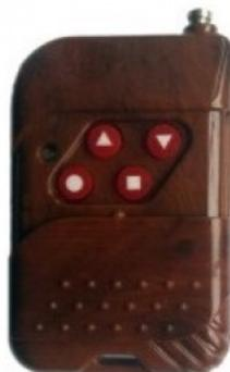
Множество устройств с радиуправлением основаны на приемниках с фиксированным кодом. И эта розетка — из их числа.
